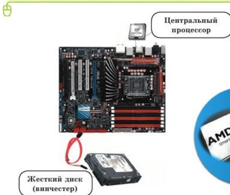
Рис. 4. Процессор и жесткий диск на системной плате
